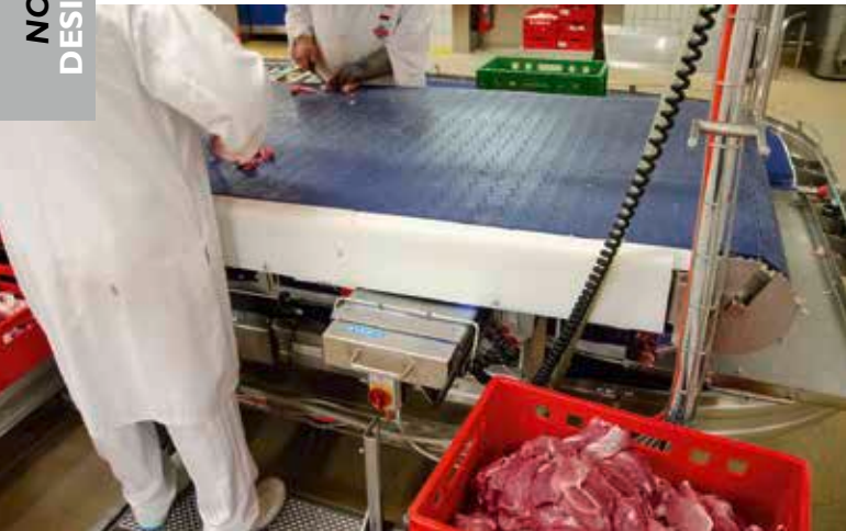
Die Banddesinfektion (Bild li.) ist unter dem Band montiert. Die Durchlaufdesinfektion (re.) erleichtert mit einem Split-Band die Entkeimung. / The belt disinfectant (left pic.) is mounted under the belt. The continuous disinfection (r.) facilitates disinfection with a split belt.
