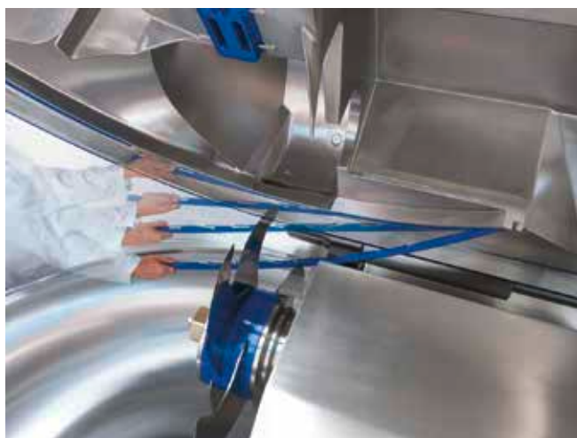
Der patentierte Messerdeckelstreifen ist auch in den neuen Kuttern verbaut. / The patented knife lid strip is also part of the new cutters.
