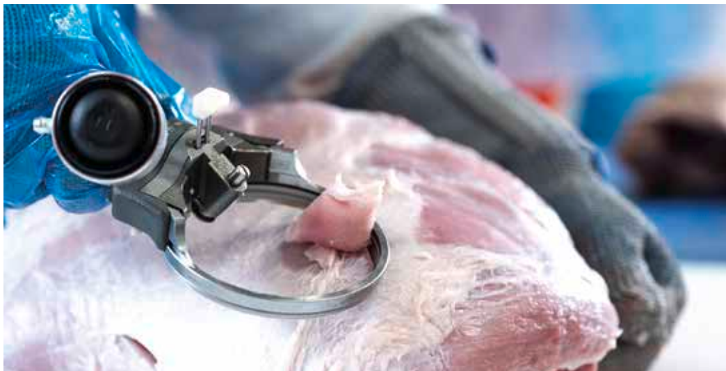
Müller Fleisch nutzt die Hochleistungstrimmer unter anderem in der Schinkenverarbeitung und in der Bearbeitung von Schweinelachs. Die Fleischstücke werden mit dem Trimmer entfettet und von Unebenheiten befreit. / Müller Fleisch uses the high-performance trimmers, among other things, in ham processing and in the processing of pork salmon. The pieces of meat are degreased and freed from unevenness with the trimmer.
