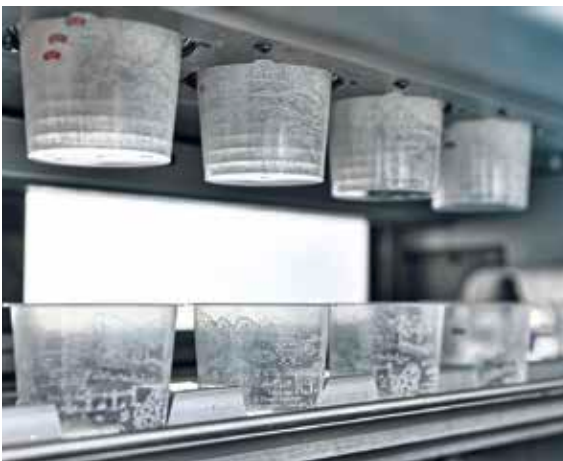
Das von Sealpac entwickelte Walking-Beam-System sorgt für eine exakte Positionierung der Trays unter den Füllköpfen, um eine Kontamination des Becherrandes zu verhindern. / The walking beam system developed by Sealpac ensures exact positioning of the trays under the filling heads to prevent contamination of the cup rim.
