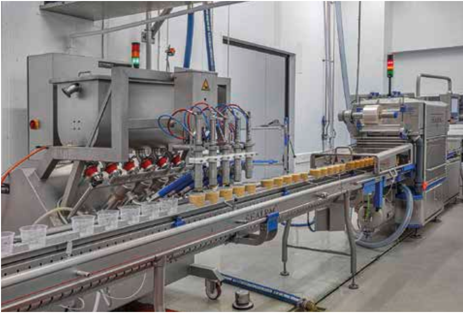
Die MatBørsen AS investierte in eine komplette Linie für den innovativen Click-on-Suppenbecher, die hauptsächlich auf Equipment von Sealpac basiert. / MatBørsen AS invested in a complete line for the innovative click-on soup cup, mainly based on equipment from Sealpac.
