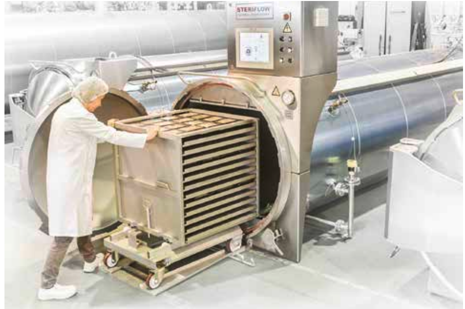
Die Körbe mit den Pet-Food-Produkten sind so konstruiert, dass das Prozesswasser ungehindert ablaufen kann.
