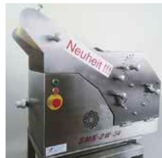
Der Schnitzelmaster, der traditionelles Fleischklopfen ersetzt, arbeitet mit dem bewährten Verfahren zur Fleischmürbung, dem „Mastern®“. Dabei wird die Fleischfaser nicht gepresst oder gequetscht, sondern gedehnt. Mit den Geräten des gleichnamigen Unternehmens lassen
