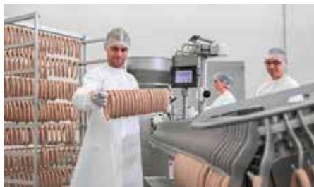
Eine neue Aufhänge-Einheit AHE 228-17 sorgt für mehr Effizienz und Gewichtsgenauigkeit.
