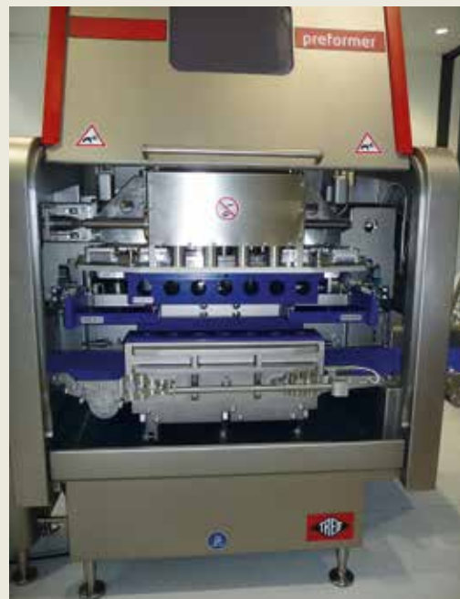
Der Falcon preformer bringt naturbelassene Produkte in Form und führt sie automatisch dem Schneidprozess zu.
