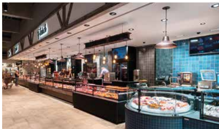
Steuerbare Speziallichtfarben sorgen an den Frischetheken für eine authentische Warenwirkung und für geringere Abschriften bei Fleisch und Wurst.
