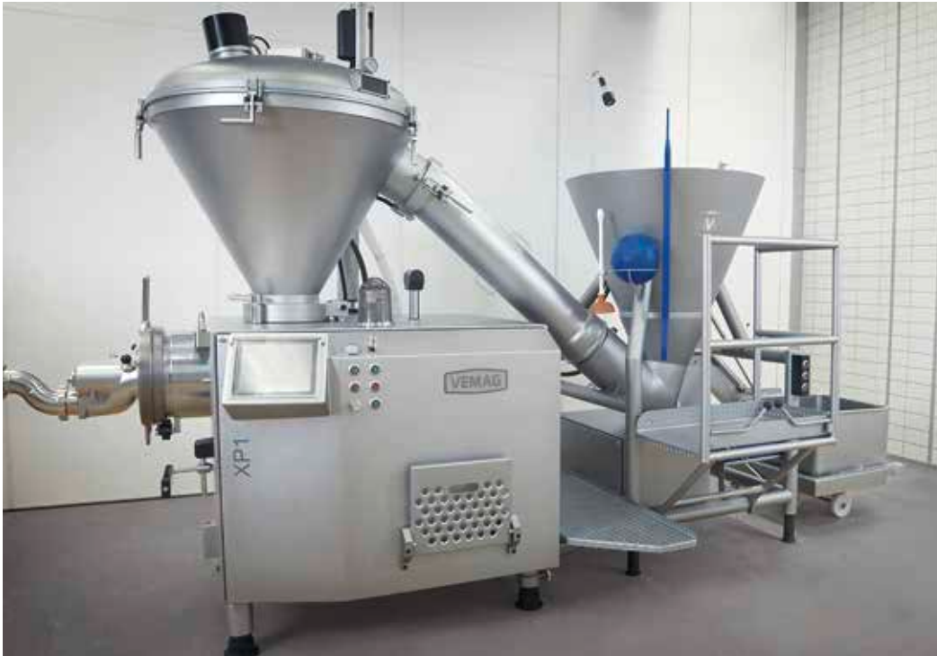
▲ Perfekte Evakuierung: Das Total Vaccum Prinzip basiert auf einer Vakuumfüllmaschine mit Vakuum- und Vorratsstrichter. / Perfect evacuation: The Total Vaccum principle is based on a vacuum filling machine with vacuum and supply hopper.
