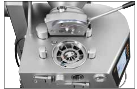
Schonend produzieren mit dem Flügelzellenförderwerk. / Gentle production with the vane cell conveyor.
