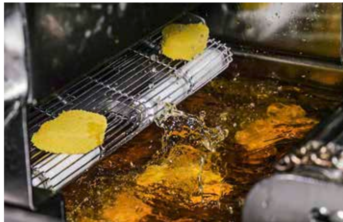
▼ In der Durchlauffritteuse AGF PRO werden die Chicken-Produkte bei Temperaturen bis zu 200°C gebraten. / In the AGF PRO continuous fryer, the chicken products are fried at temperatures up to 200°C.
