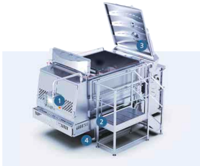
Der AMP-Mixer von alco food machines wird mit einer SPS-Steuerung per Touchpanel (1) bedient. Die Cryo-Injection (2) kühlt die Produktmasse durch das Einsprühen von Cryo-Medien wie CO 2 oder Stickstoff. Die Vakuumausrüstung (3) optimiert den Eiweißausschluss und vermeidet Gaseinschlüsse im Produkt. Die implementierte Wägetechnik (4) erlaubt die Nutzung der Mischanlage als Chargenwaage. / The AMP mixer from alco food machines is operated with a PLC control via touch panel (1). The cryo-injection (2) cools the product mass by spraying in cryo-media such as CO 2 or nitrogen. The vacuum equipment (3) optimizes protein exclusion and avoids gas inclusions in the product. The implemented weighing technology (4) allows the mixing plant to be used as a batch scale.
