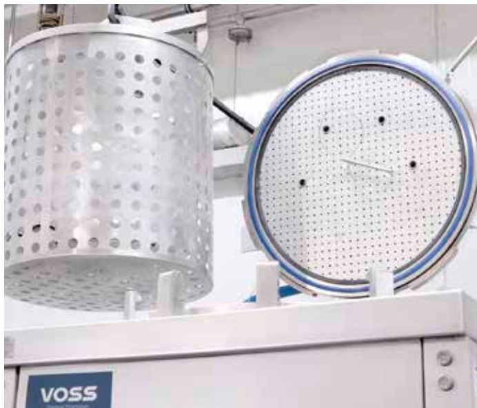
^ Bei Voss feiert Einweckgläser gerade ihre x-te Renaissance. Die Autoklaven steuern die meisten Arbeitsschritte des Koch- und Garprozesses mit individuell einstellbaren Programmen. / At Voss, preserving jars are currently celebrating their umpteenth renaissance. The autoclaves control most steps of the cooking and simmering process with individually adjustable programs.
