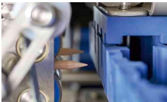
^ Convenience-Technik in Reinkultur sind die Skewer Systeme von Miveg. Sie positionieren die Holzspieße auf den Zehntelmillimeter genau und liefern Grillspieße in hohen Stückzahlen per Knopfdruck. / Convenience technology in its purest form are the skewer systems from Miveg. They position wooden skewers precisely to the tenth of a millimeter and deliver barbecue skewers in high quantities at the push of a button.
