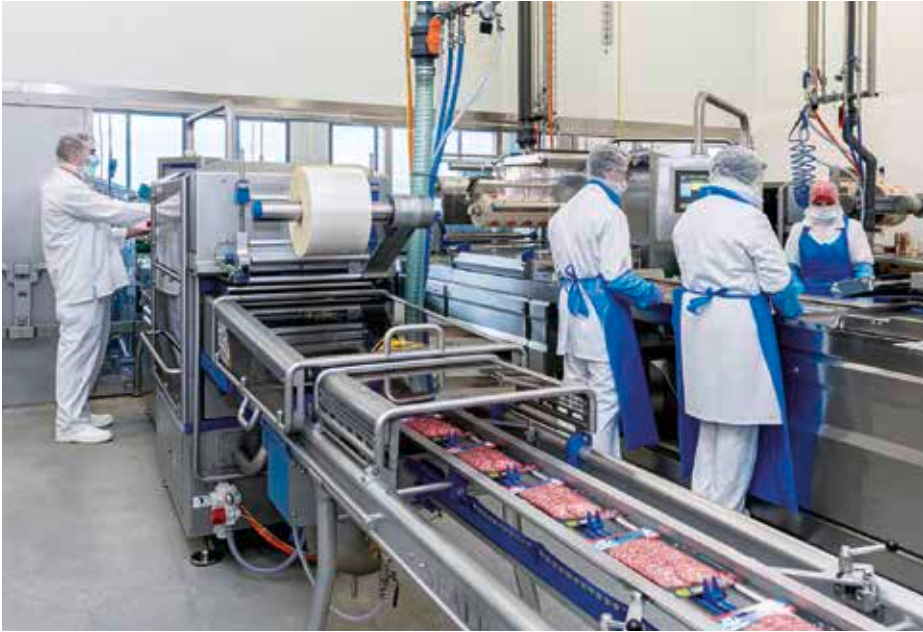
^ Die FlatMap-Verpackungen werden bei Bigler auf einem Sealpac Traysealer A7 prozesssicher versiegelt. Mit der kompletten Sichtbarkeit des Produkts sind sie echte Eyecatcher. / At Bigler, the FlatMap packages are sealed on a Sealpac Traysealer A7 in a process-safe manner. With complete visibility of the product, they are real eye-catchers.
