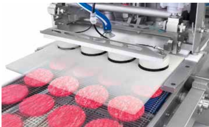
^ Der GEA MaxiFormer ist eine Trommelformmaschine mit rotierender Trommel zur Fertigung geformter Produkte. Er eignet sich zur Großproduktion von Hähnchen-Nuggets, Popcorn, Filets, Patties und Steaks. / The GEA MaxiFormer is a drum forming machine with a rotating drum for the production of formed products. It is suitable for the large-scale production of chicken nuggets, popcorn, fillets, patties and steaks.
