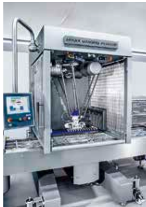
Singer-Roboteranlagen – zum Einlegen von Produkten direkt in die Verpackungsmaschine.
