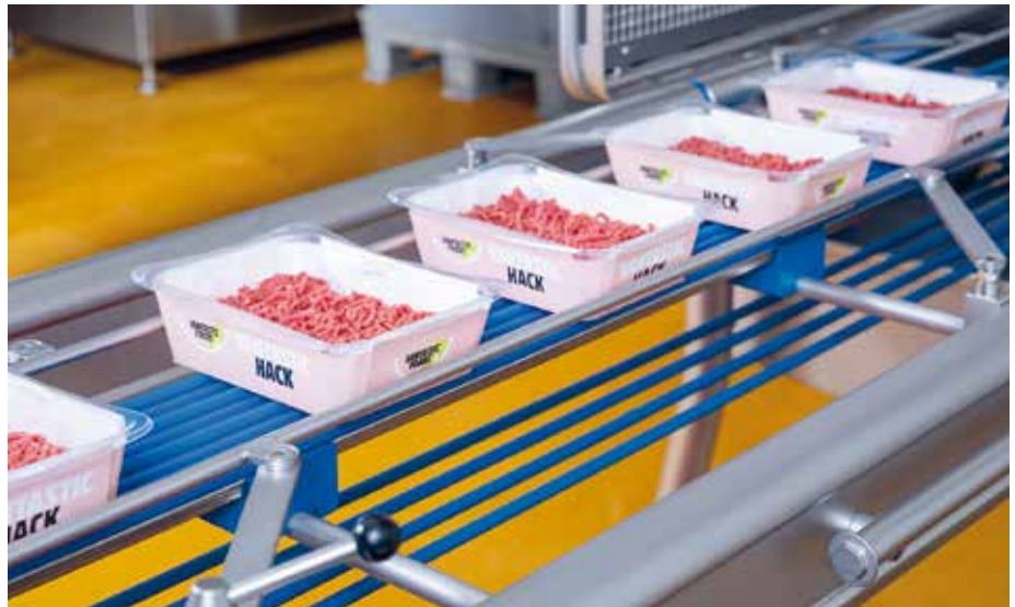
Die Schalen werden im Verpackungsprozess mit hoher Taktzahl vollautomatisch abgestapelt und befüllt.
