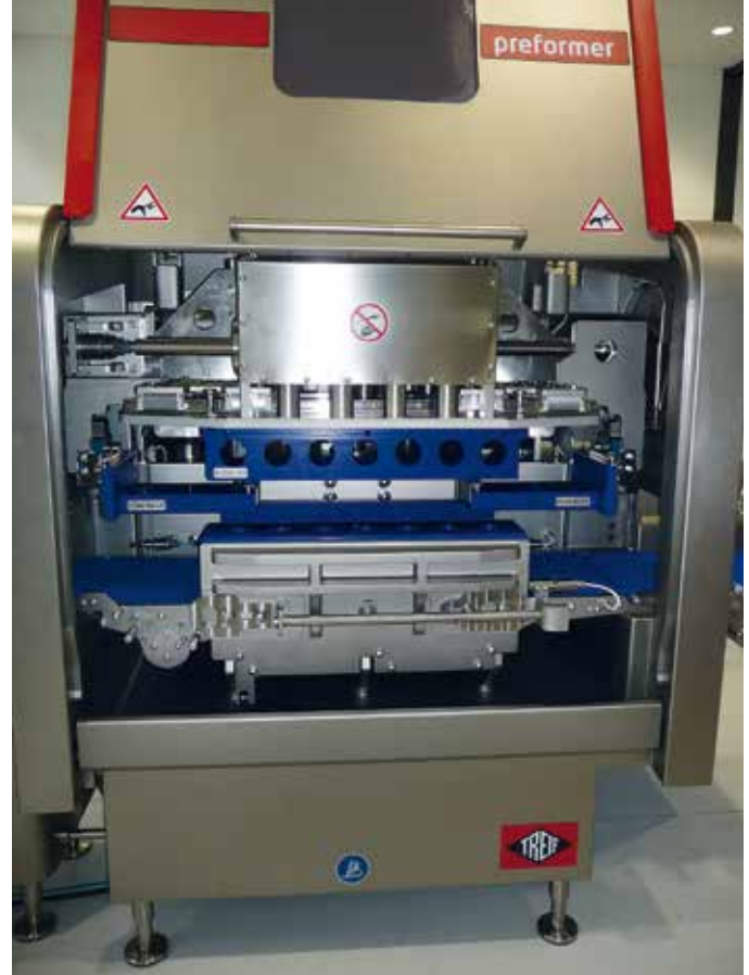
Mit dem Falcon preformer werden naturbelassene Produkte in Form gebracht und automatisch dem Schneidprozess zugeführt.
