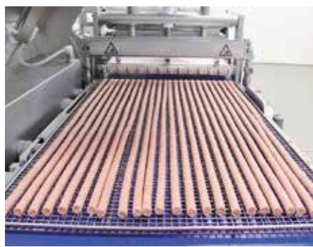
Produktion von Pet Food mit dem 24-bahnigen Formsysteem FS 510. / Production of pet food with the 24-lane forming system FS 510.
