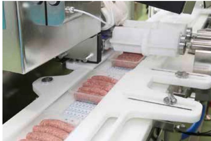
Frische Bratwürste werden mit dem Link Loader LL335 vollautomatisch gruppenweise in Schalen abgelegt und an den Folgeprozess weitergegeben. / The cut fresh grilling sausage is placed into trays in groups automatically with the help of the link loader LL335 and conveyed into the subsequent processing.
