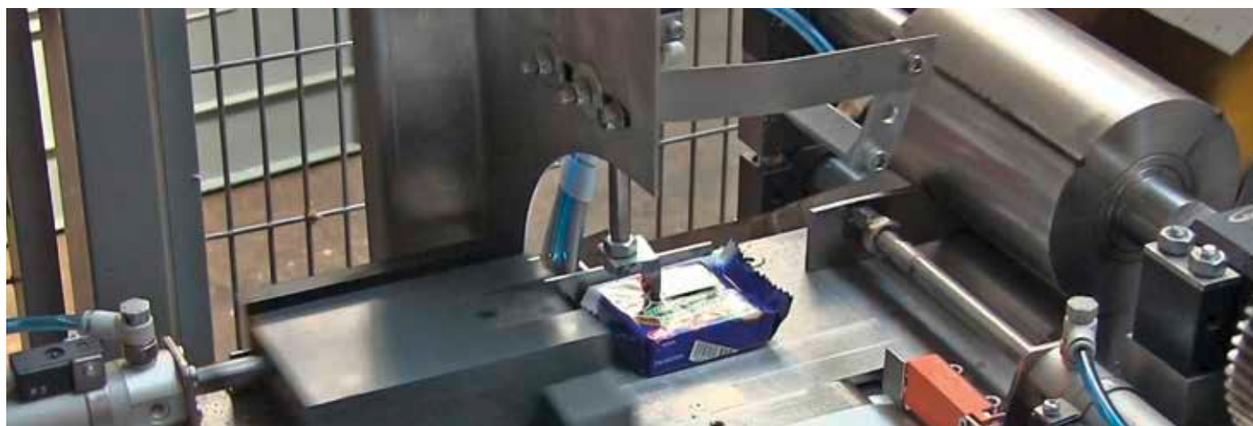
Eine Walze mit scharfen Klingen (re.) entpackt die Produkte. / A roller with sharp blades (r.) unpacks the products.
