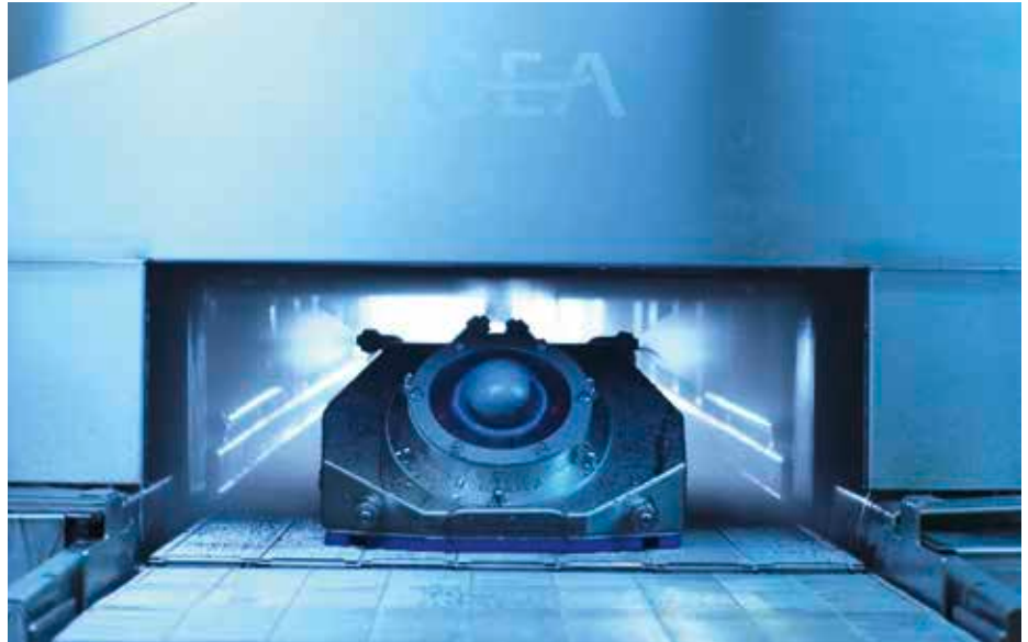
Die Lösung vom Institut Fraunhofer IVV heißt Mobile Cleaning Device und ist ein selbstfahrendes, voll automatisiertes Reinigungssystem.
