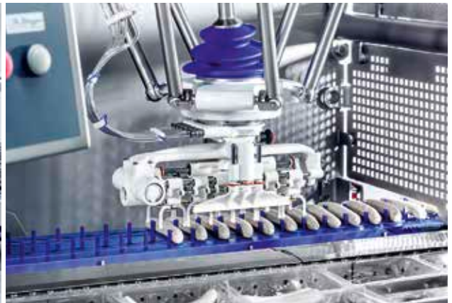
Loading system Typ V-G-E – zum Einlegen von Produkten direkt in die Verpackungsmaschine.
