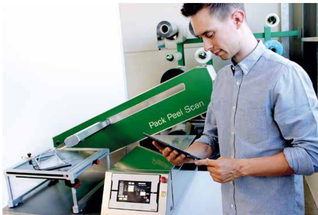
Mit „Pack Peel Scan“ können die Öffnungskräfte thermogeformter, peelbarer Verpackungen überprüft werden.
