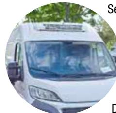
Seit 1.9.2019 können manche Aufbauten nicht mehr realisiert werden. Es gibt hier nun Grenzen bezüglich der Aufbauhöhe eines Kühlkoffers sowie des Gewichts um die Abgasgrenzwerte einzuhalten. Das sollte vor Beginn eines Kühlkofferaufbaus abgeklärt sein.
