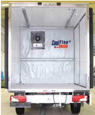
Eine Innovation von Kiesling: Sprinter mit eigenem Kühlaufbau und der Trennwand Cool Flap®.
