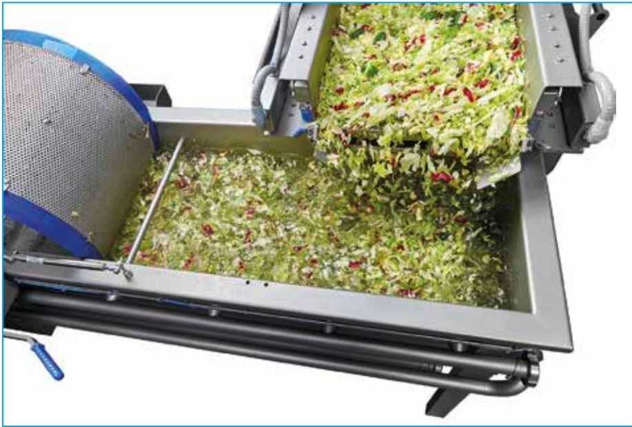
Waschvorgang mit Mischsalat: Vibrationsaustrag und Insektenaustrag der Waschmaschinen GEWA 3800V Plus in der Salat- und Gemüseverarbeitungslinie von Kronen. / Washing process with mixed salad: vibration discharge and insect discharge by the washing machines GEWA 3800V Plus in the salad and vegetable processing line of Kronen.
