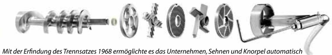
Mit der Erfindung des Trennsatzes 1968 ermöglichte es das Unternehmen, Sehnen und Knorpel automatisch vom Fleisch zu trennen und auszusortieren. Im Bild links: Das Trennergebnis.
