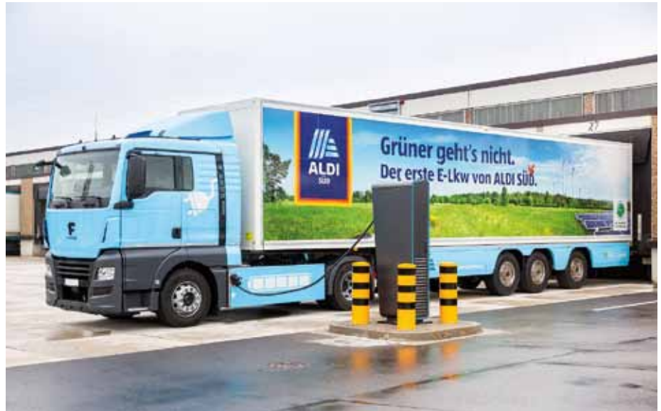
Der E-Lkw von Aldi Süd ist nach Angaben des Discounters der erste rein elektrisch betriebene 40-Tonnen-Sattelzug mit Kälteaggregat im deutschen Lebensmittelmitteleinzelhandel.
