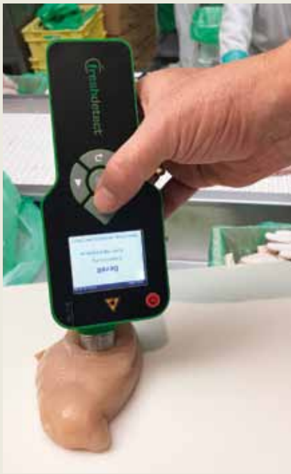
Mit dem mobilen Handmessgerät BFD-100 kann jetzt auch die Gesamtkeimzahl von Hähnchenbrust bestimmt werden.
