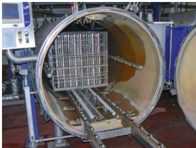
Для стерилизации мясо поступает в автоклав в корзинах, которые могут принять примерно одну тонну баночной массы.
