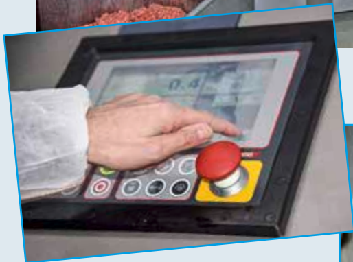
Über das serienmäßig integrierte Touchpanel lassen sich die Software-Lösungen Cutvision und Cutcontrol ansteuern.
