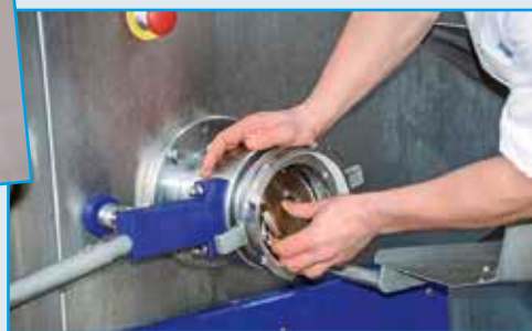
Zum Säubern ist die Sortiereinrichtung ohne Werkzeug in Sekunden ab- und wieder anmontiert.
