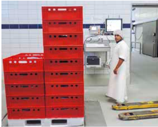
Am Zerlegeausgang wird die Palette gewogen und erhält ein Barcode-Etikett. / The pallet is weighed at the disassembly exit and is given a barcode label.
